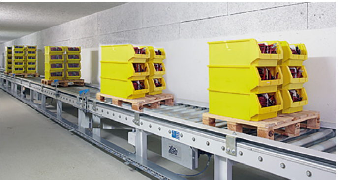
Convoyeur entièrement automatique entre l'entrepôt et la production
