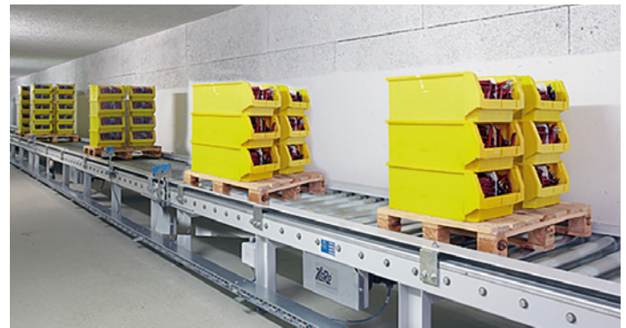
Vollautomatisches Förderband zwischen Lager und Produktion
